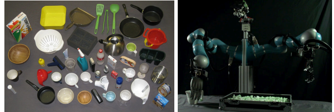
Rysunek 1: Cztery obiekty użyte do uczenia pięciu chwytów oraz 43 obiekty użyte do testów transferu chwytów (po lewej stronie). Robot Borys (na prawo).
